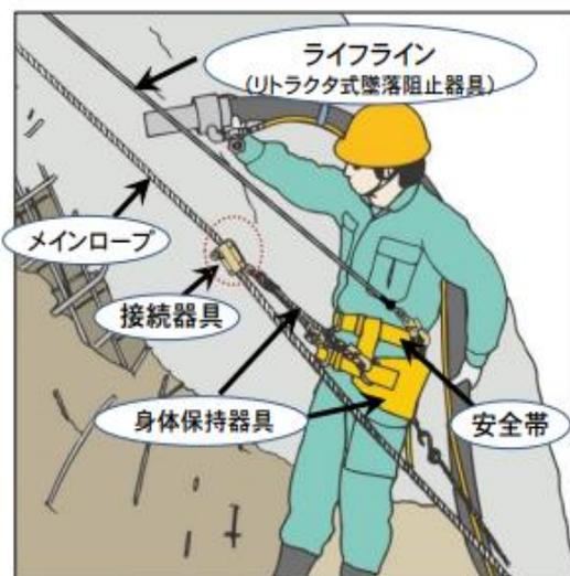
のり面保護工事でのロープ高所作業の例
