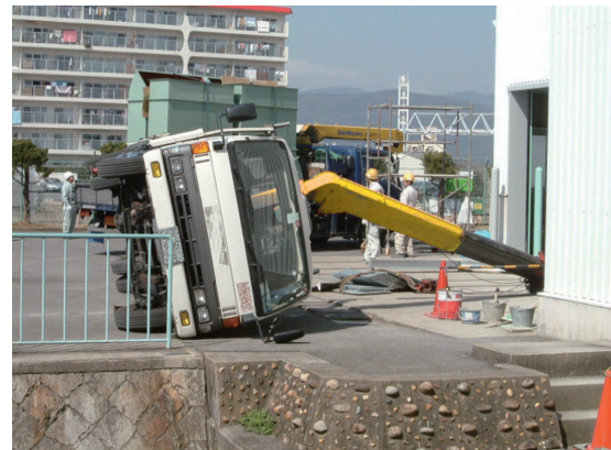
積載形トラッククレーンの転倒
